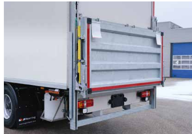
PLATAFORMA ELEVADORA PARA FACILITAR LA CARGA Y DESCARGA
